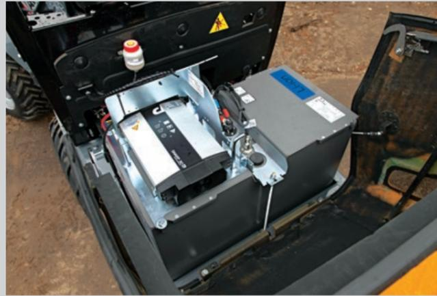
Die G2700E-Modelle sind einfach zu warten, da die Wartungspunkte leicht zugänglich sind. Das Hydrauliksystem und die Batterie können durch die leicht zu öffnenden Wartungsklappen gut erreicht werden. Dies stellt sicher, dass tägliche Überprüfungen und die Wartung schnell und sicher durchgeführt werden können.
