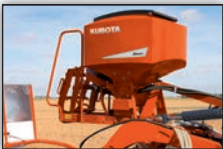
Zásobník osiva SH200 nebo SH500 o objemu 200 nebo 500 litrů pro setí meziplodin edním přejezdem během zpracování strniště.
