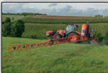
Boom Guide - ISOBUS kompatibilní postřikovač s ultrazvukovým vyrovnáním ramen.
