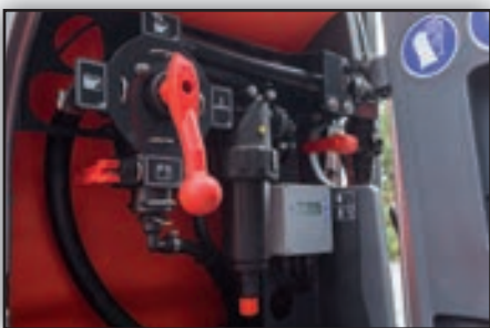
Ovládací panel Easy Set dělá život snazší díky intuitivnímu ovládní. Dva samostatné ventily – jeden sací a jeden tlakový.
