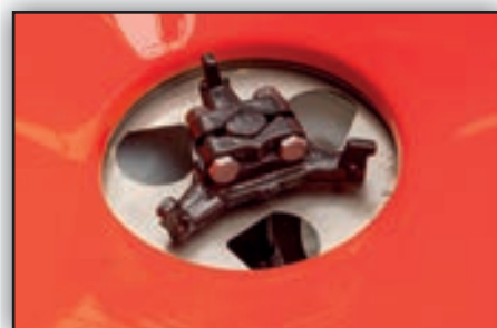
Čechrač zajišťuje rovnoměrný tok hnojiva.
